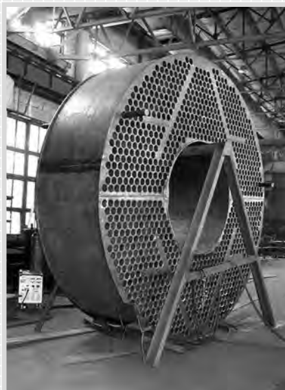
Строительство греющей камеры вакуум-аппарата на ГМЗ / Construction of the vacuum pan calandria at Grebenky Machine-Building Plant (GMZ)
