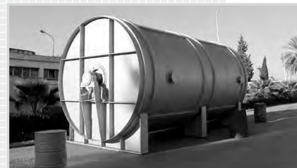
Приемная мешалка утфеля на сахарном заводе в Гуэлме (Алжир) / Masseccuite receiver at Guelma Refinery (Algeria)
