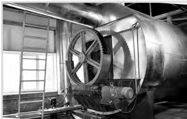
Приемная утфелемешалка ТМУ90 на Буинском сахарном заводе / TМУ90 massecuite receiver at Buinsky Sugar Refinery
