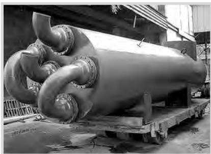
Отгрузка подогревателя диффузионного сока на Гребенковском машиностроительном заводе / Shipment of raw juice heater from Grebinky Machine-Building Plant
