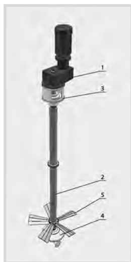
3D-модель мешательного устройства вакуум-аппарата / 3-D model of vacuum pan stirrer
