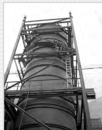
Кристаллизатор ТКВ на Скидельском сахарном заводе (Беларусь) / TKV Cooling Crystallizer at Skidel Sugar Refinery (Belarus)
