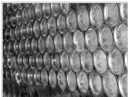
Строительство греющей камеры вакуум-аппарата на ГМЗ / Construction of the vacuum pan calandria at Grebenky Machine-Building Plant (GMZ)
