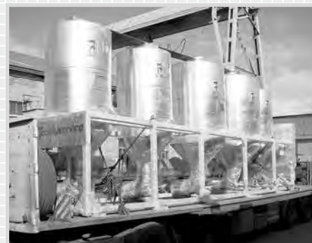
Выпарная станция для цеха лимонной кислоты Скидельского с.к. / Evaporation station for the citric acid production section of Skidel Sugar Factory
