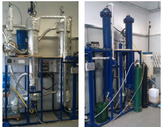
(54) ПРОМИСЛОВА СИСТЕМА ВИРОБНИЦТВА ЗНЕВОДНЕННОГО ХАРЧОВОГО ЕТИЛОВОГО СПИРТУ (57) Реферат: Промислова система виробництва зневодненого харчового етилового спирту зі спиртової браги, що містить сполучені системою трубопроводів браговеретінну колону, оснащену підігрівачем браги, евіораційну колону та колону остаточного очищення з дефлегматором, конденсатором та холодильним охолодження цільового продукту, прийому систему містить блок зневоднення, вхід якого зв'язаний з виходом браговеретінної колони, а вихід - зі входом евіораційної колони.
