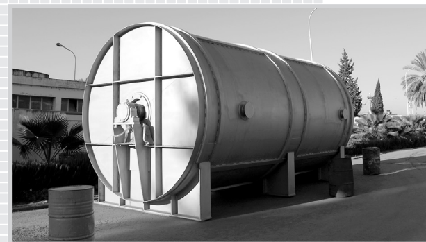
Приемная мешалка утфеля на сахарном заводе в Гуэлме (Алжир) / Massecuite receiver at Guelma Refinery (Algeria)
