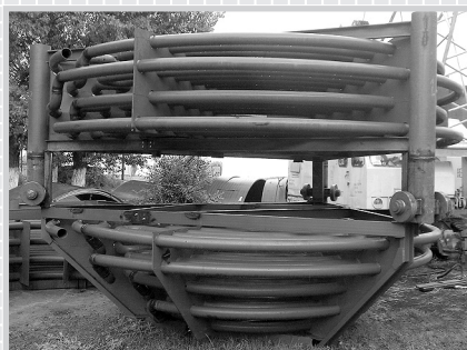
Секции теплообменника вертикального кристаллизатора ТКВ / Heat exchanger sections of TKV cooling crystallizer
