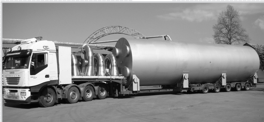
Отгрузка подогревателя диффузионного сока на Гребенковском машиностроительном заводе / Shipment of raw juice heater from Grebinky Machine-Building Plant
