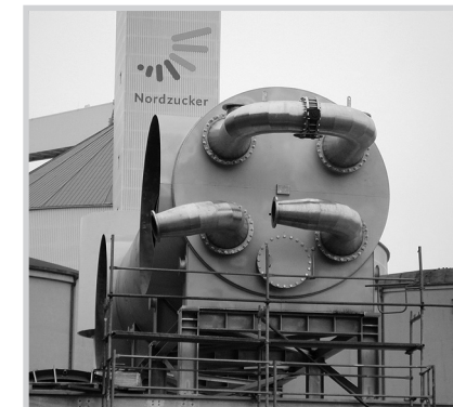
Подогреватель диффузионного сока ТПДУ-1236 на заводе Nordzucker AG / Raw juice heater TPDU-1236 mounted at the Nordzucker refinery
