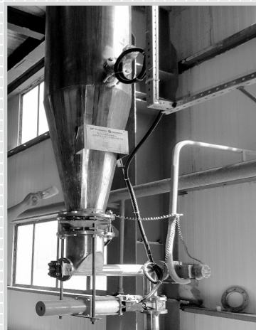
Шнек-дозатор для подачи серы в печь. / Dosing screw for feeding sulfur into the burner.
