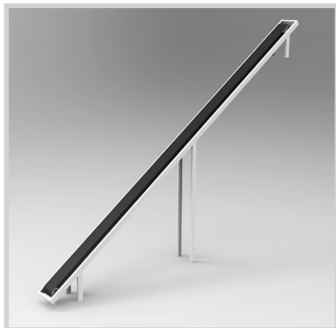
Конвейер подачи угля / Coal feeder conveyor
