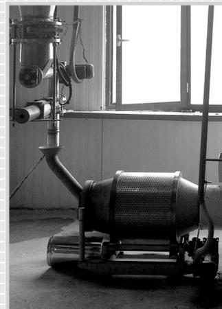
Сернистая печь станции сульфитации / Sulfur burner of the sulfitation station
