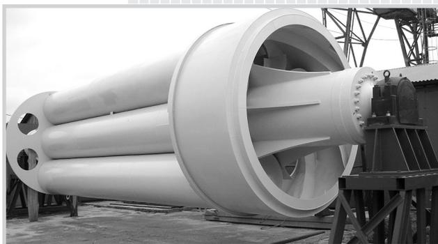
Изготовление установки сушки сахара на ГМЗ /
