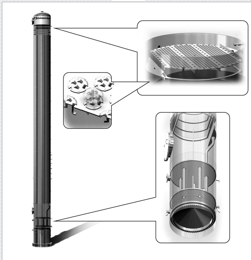
3D-модель массообменной колонны / 3-D model of mass transfer column
