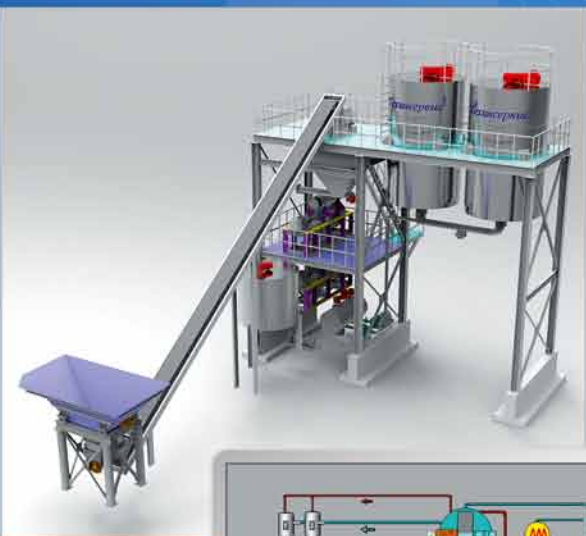
Станция приготовления и сжигания ВУТ
